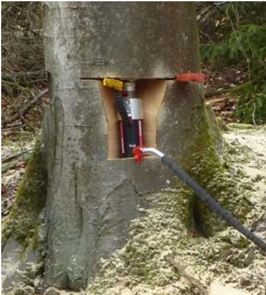
Eingebauter und vorgespannter Hebezyylinder
