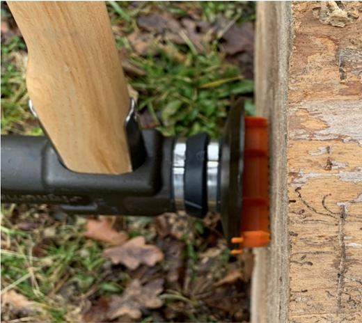
**Achtung: Der Riss muss sich zwischen den zwei inneren Querstegen befinden.**
