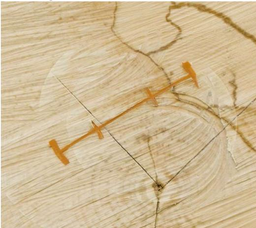
Die Klammer muss mit dem ersten Schlag eingeschlagen werden. Beim einem etwaigen Nachschlagen wäre Splitterungsgefahr.
