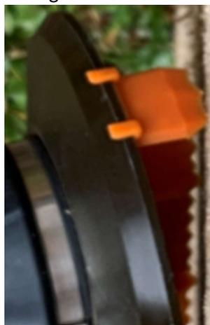
3. Einschlagteller parallel zur Stirnseite vom Holz ausrichten und die Klammer möglichst mit einem Schlag einschlagen.
