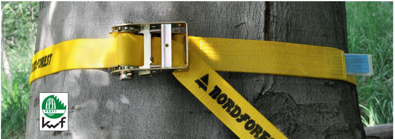
Die Stammpresse Bär schützt in Spannung befindliche Bäume bei der Fällung oder Aufarbeitung vor dem Aufreißen. Sie wird um den zu fällenden oder aufzuarbeitenden Stamm dicht oberhalb des Sägeschnittes gespannt.
