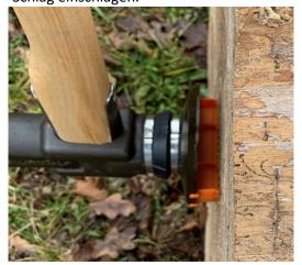
Achtung: Der Riss muss sich zwischen den zwei inneren Querstegen befinden.
